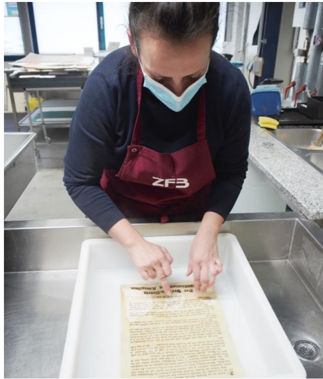
Nach der Trockenreinigung legt Nicole Klinger das Flugblatt vorsichtig ins Wasserbad. Die Druckfarbe ist nicht wasserlöslich.
